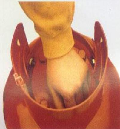
⑤ 左手把持喷粉枪管托，右手把持枪把用手指扳动喷粉开关，对准火焰喷射，不断靠前左右摆动喷粉枪，把干粉笼罩住燃烧区，直至把火扑灭为止。
